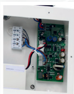
Inkoppling sker på list i lådans botten
